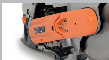
Лёгкий запуск двигателя обеспечивает декомпрессионный клапан.
