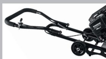
Складные ручки и транспортные колёса значительно упрощают транспортировку устройства.
