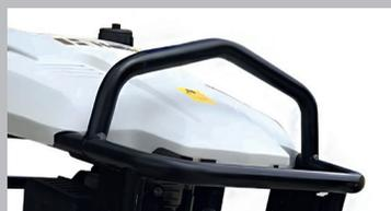
Петля для перемещения грузоподъёмными механизмами.
