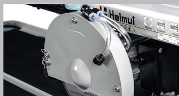
Подача воды в зону реза с двух сторон, что позволяет быстро охладить диск.
