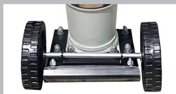
Наличие колёс значительно упрощает транспортировку вибротрамбовки.
