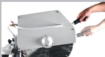
Станок имеет функцию вертикального хода, которая позволяет распиливать материал от 70 до 125 мм.
