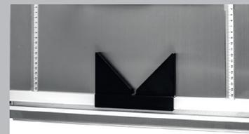
Параллельный упор с линейкой позволяет точно выставить плитку без необходимости разметки.
