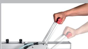
Станок имеет функцию вертикального хода, которая позволяет распилить материал от 40 до 45 мм.
