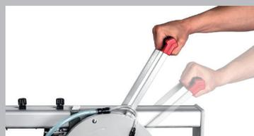
Станок имеет функцию вертикального хода, которая позволяет распилить материал от 46 до 52 мм.
