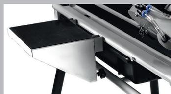
Станок оснащён съёмным столиком, который в случае необходимости расширит рабочую поверхность.
