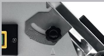
Система наклона даёт возможность осуществлять резку плитки и камня под углом 45°.
