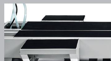
Станок оснащён двумя съёмными столиками, которые в случае необходимости расширяют рабочую поверхность.
