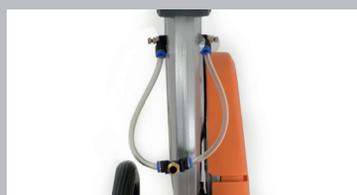
Подача воды в зону реза с двух сторон.
